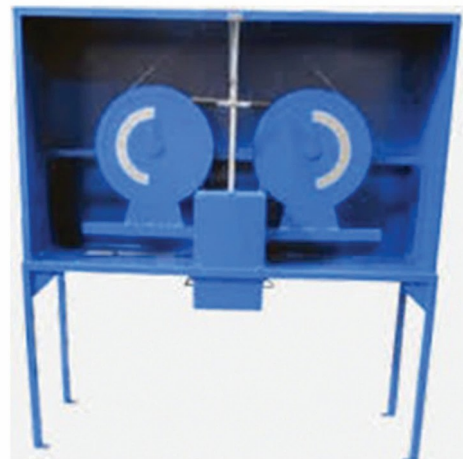
شکل ۶. دستگاه سنجش اندیس ضربه باند.
