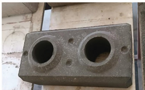
آجر تولید شده از باطله معدن مس کوه خیری - شرکت زمین‌کاوان زمان
